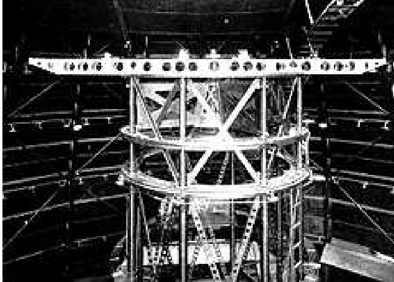
Fig. 1.1.— Le train optique de Michelson placé sur le télescope de Hooker à Mount Wilson en Californie. Avec ce dispositif, Michelson et Pease mesurèrent les diamètres de plusieurs étoiles super-géantes. Les quatre miroirs utilisés pour augmenter la résolution du télescope sont tout juste visible sur le dessus de la poutre. (Image : Musée de l'Observatoire du Mt. Wilson)
